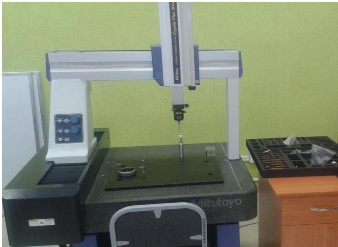
Рис. 7. Портальная КИМ Mitutoyo Crysta-plus M443
