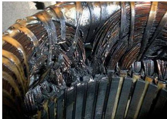
в) – обрыв одной фазы обмотки статора
