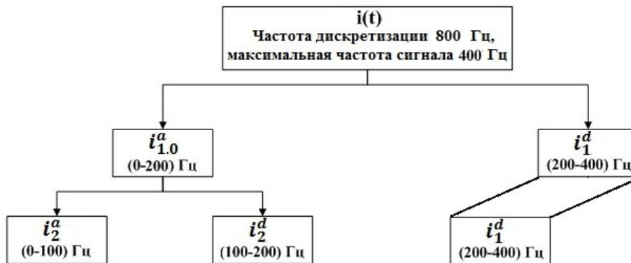
Рис. 2. Схема дискретного вейвлет-преобразования
