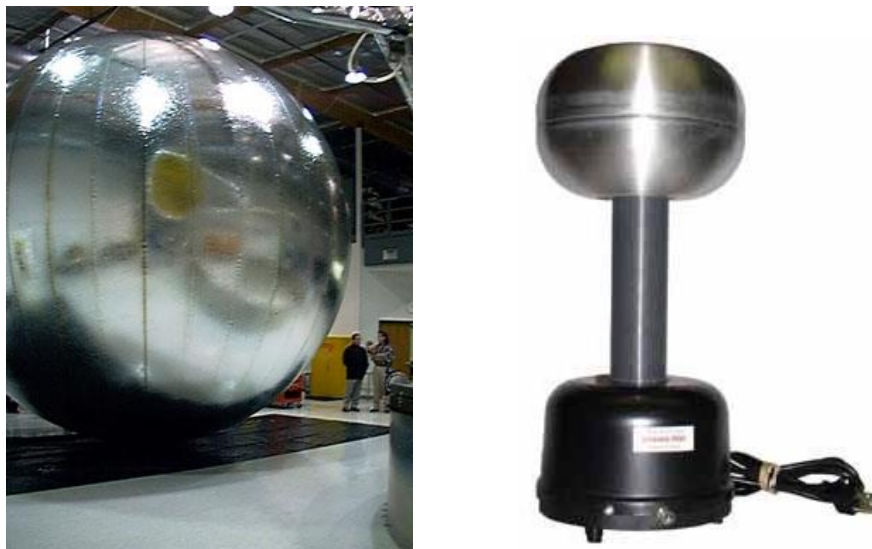
Рис. 3. Алюминиевая сфера и генератор Ван де Граафа [11]
