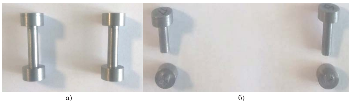
Рис. 3. Фотографии образцов: а – образцы до испытания; б – образцы после испытания
