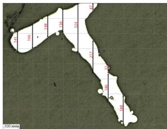
Рис. 5. Микрофотографии поддерживающих структур 1.5×1.5 мм с нанесенной сеткой и значениями толщины (мкм) в месте пересечения
