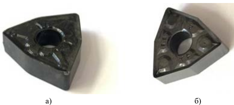
Рис. 3. Результат переточки многогранных твердосплавных пластин: а) изношенная пластина, б) переточенная пластина
