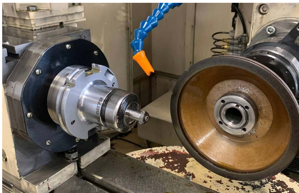
Рис. 2. Технологическая наладка для переточки многогранной пластины
